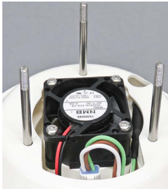
Abbildung 6: Kabelführung nach Aufsetzen der zweiten Schutzkappe
