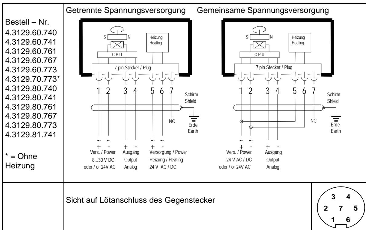
Abbildung 3: Anschlussschaltbild für Ausführung mit Stecker
