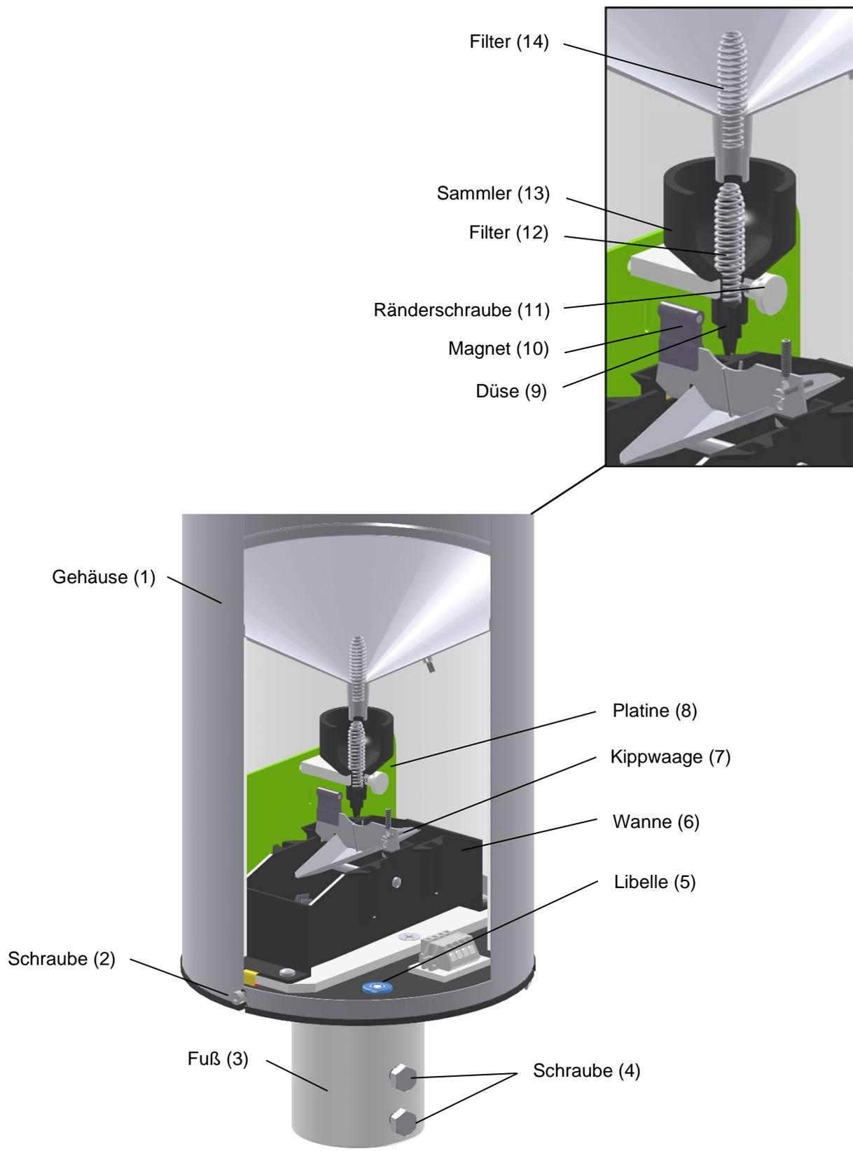
**Abbildung 3: Geräteaufbau**
