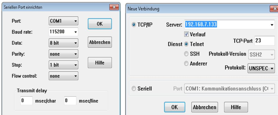
Abbildung 20: Beispiel Mikro USB (links) und Telnet (rechts) Konfiguration in Tera Term
