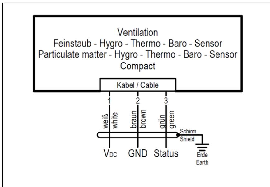
Abbildung 1: Anschlussschaltbild der Ventilation
