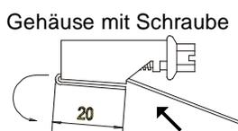
**Abbildung 4: Spannbandgehäuse**
