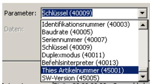
Abbildung 11 : Auswahlbox, Terminal für MODBUS-RTU Interpreter (Registerauswahl)
