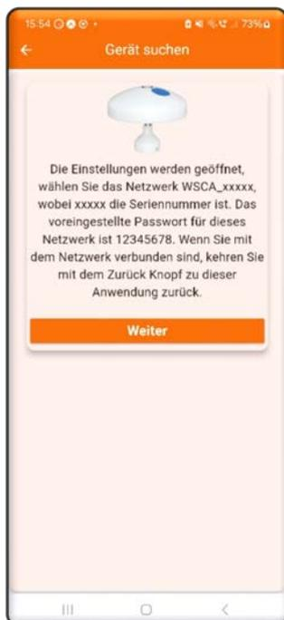
Es folgt ein Dialog mit einer Beschreibung der Einstellungen des Mobiltelefons. Diese Einstellungen können nicht automatisiert vorgenommen werden und unterscheiden sich je nach verwendetem Mobiltelefon. Im nächsten Schritt muss die WLAN-Verbindung zur WSCA hergestellt werden. Hierzu stellt die WSCA ein eigenes WLAN-Netzwerk zur Verfügung (SoftAP-Mode). Der Netzwerkname beginnt mit „WSCA\_“ gefolgt von den letzten 5 Stellen der Seriennummer.
