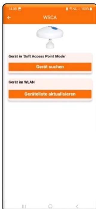
Es erscheint ein Dialog, in dem zwischen der Suche eines neuen Sensors und der Anzeige von bestehenden Sensoren gewählt werden kann. Zum Einrichten eines neuen Sensors muss hier der Schalter „Gerät suchen“ gedrückt werden.
